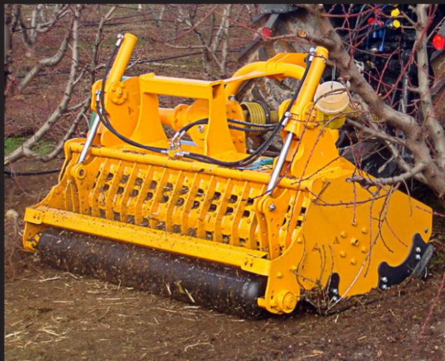
Trituradora polivalente para la eliminación de restos de poda, en cítricos, frutales, olivo y desbroce de materia en pie. Portón trasero hidráulico con criba, rompedores intercambiables y rodillo de control al suelo. Permite trabajar en ambos sentidos, atacando grandes volúmenes, en la misma posición de enganche. Protege al tractor de pinchazos y averías al no tener que pisar la materia a triturar.
