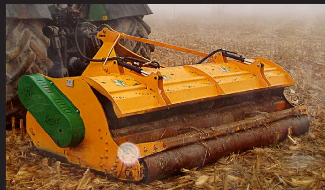
Trituradora combinada de gran potencia para tractores de hasta 270 CV. Perfecta para el picado de maíz, sorgo, girasol, algodón y pradera en grandes extensiones. Incorpora portón trasero hidráulico, con toberas orientables, para extender la materia uniformemente. Doble arrastre de tracción, que garantiza una perfecta transmisión de potencia entre el tractor y el rotor. Rotor POLSER de 725 mm de diámetro, equipado con diferentes elementos de corte: cuchillas o martillos.
