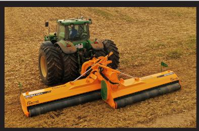
La Abatible Agrícola es una composición de dos máquinas estándar, superpuestas en el trabajo, unidas por un cuerpo central con sistema de auto plegado. La composición puede llegar a 6,30 m.
