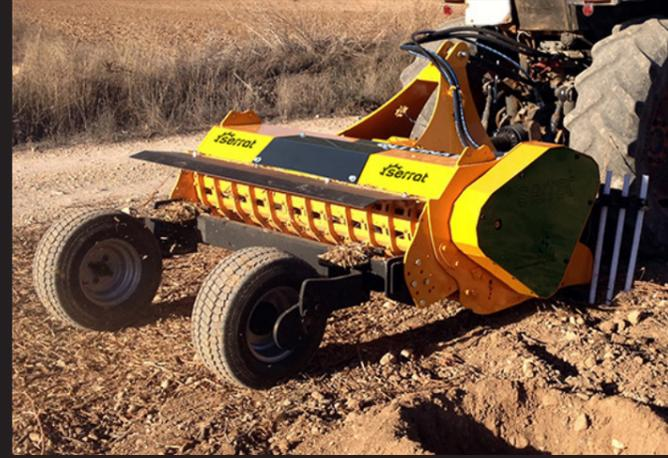
Trituradora con alimentador hidráulico reversible, para restos de viña, olivo, almendros, etc. hasta un diámetro de 50 mm.
