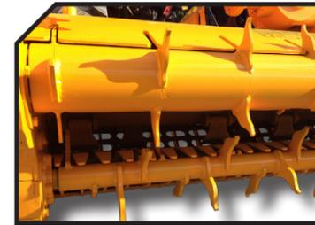
Criba trasera dentada recambiable
