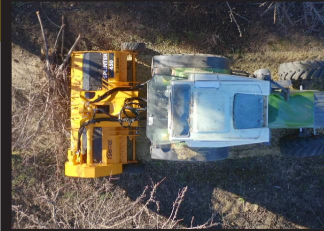
Trituradora con doble alimentador hidráulico ideal para restos de olivo, cítricos y frutos secos de hasta 80 mm de diámetro, con el rotor SPLINTER de SERRAT para tractores de entre 70 y 140 CV.
