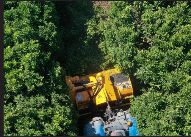
Trituradora con doble alimentador hidráulico ideal para restos de olivo, cítricos y frutos secos de hasta 100 mm de diámetro, con el rotor SPLINTER de SERRAT para tractores de entre 90 y 160 CV.
