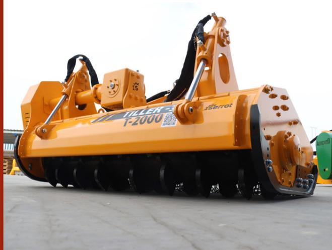
Máquina de preparación de suelo hasta una profundidad de 120 -150 mm, para tractores con Creeper o Vario entre 80 - 120 CV. Transforma terreno forestal, con tocones y rocas, en terreno para cultivo evitando accidentes en posteriores procesos.
