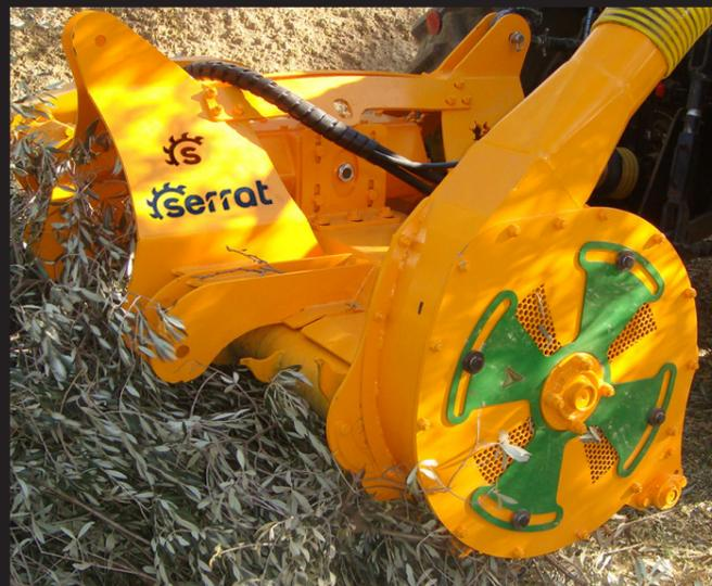
Máquina trituradora recuperadora de madera de poda en frutales, cítricos, viña, etc. para acoplar a tractores a partir de 80 CV o instalar en el tripuntal delantero de un tractor estándar de 120 - 130 CV.
